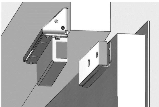
Рис. 9 Установка корпуса замка с комплектом МК AL-350FB
